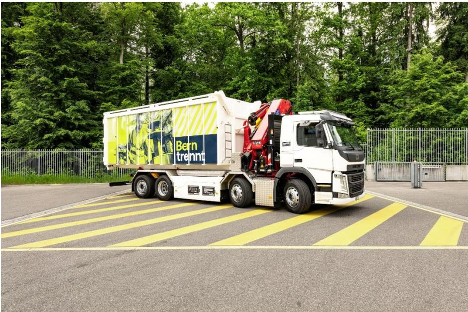
Abbildung 1: Vollelektro-Hakenfahrzeug mit Kran und 36 m<sup>3</sup> Mulde. Quelle: ERB.
