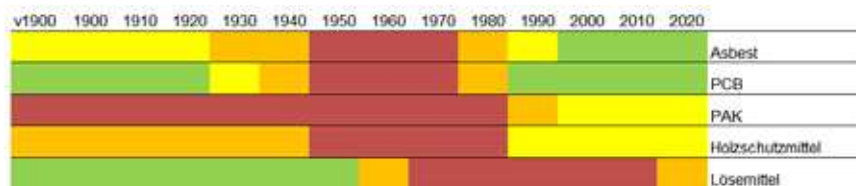
Abb. 5 Potential Gebäudeschadstoffe nach Baujahr
