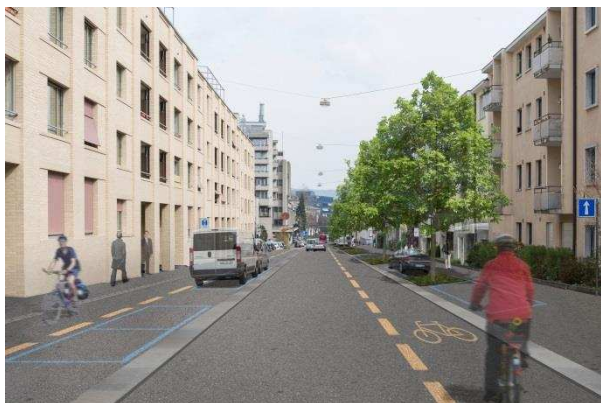
Durchlässigkeit ermöglichen mittels Einrichtung von Velogegenverkehr auf Einbahnstrassen (Grafik: Visualisierung BGK Schwarztorstrasse)
