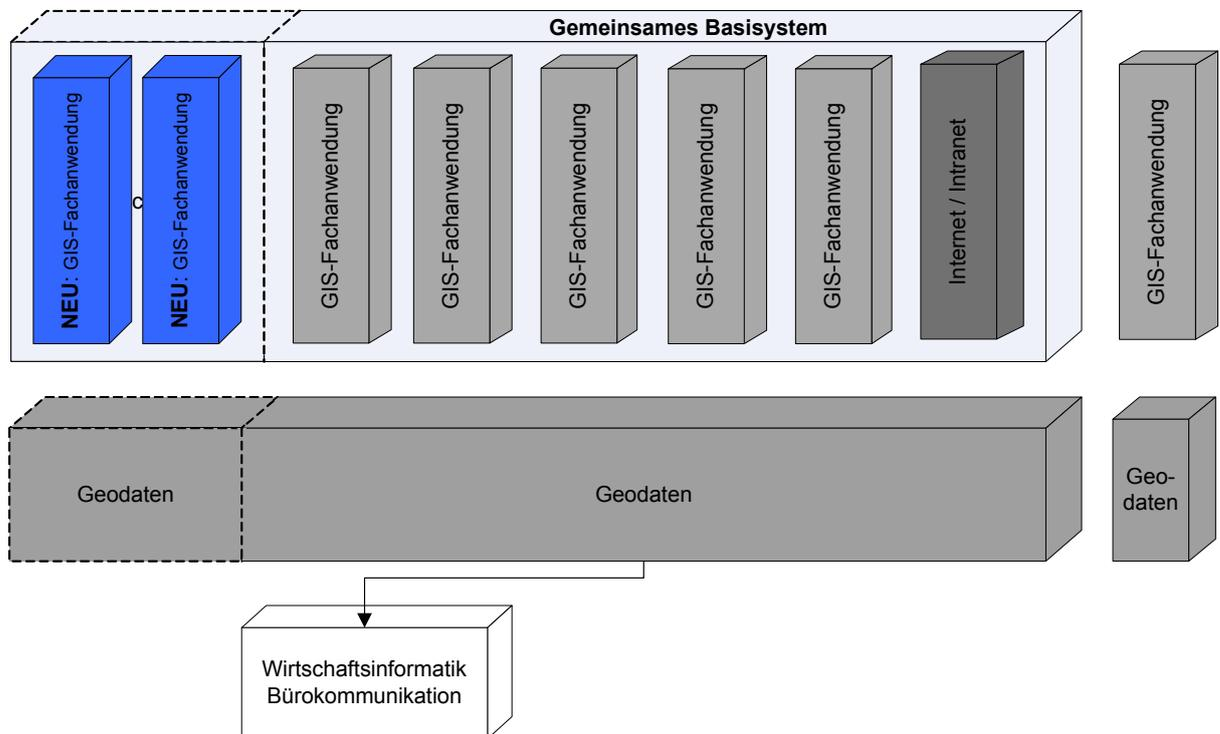
Über sogenannte Dienste (Web- und Datenservices) können die Geodaten gleichzeitig den verschiedenen Fachanwendungen und im Intranet/Internet bereit gestellt werden. Daneben werden nur einige wenige spezialisierte GIS-Fachanwendungen weiterhin dezentral bestehen (z.B. hydraulische Berechnungen).
