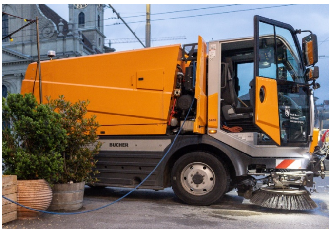
Abbildung 1: Kompaktsaugmaschine mit einem Behältervolumen von 5 m 3 von Bucher Municipal AG, die von Tiefbau Stadt Bern genutzt wird.
