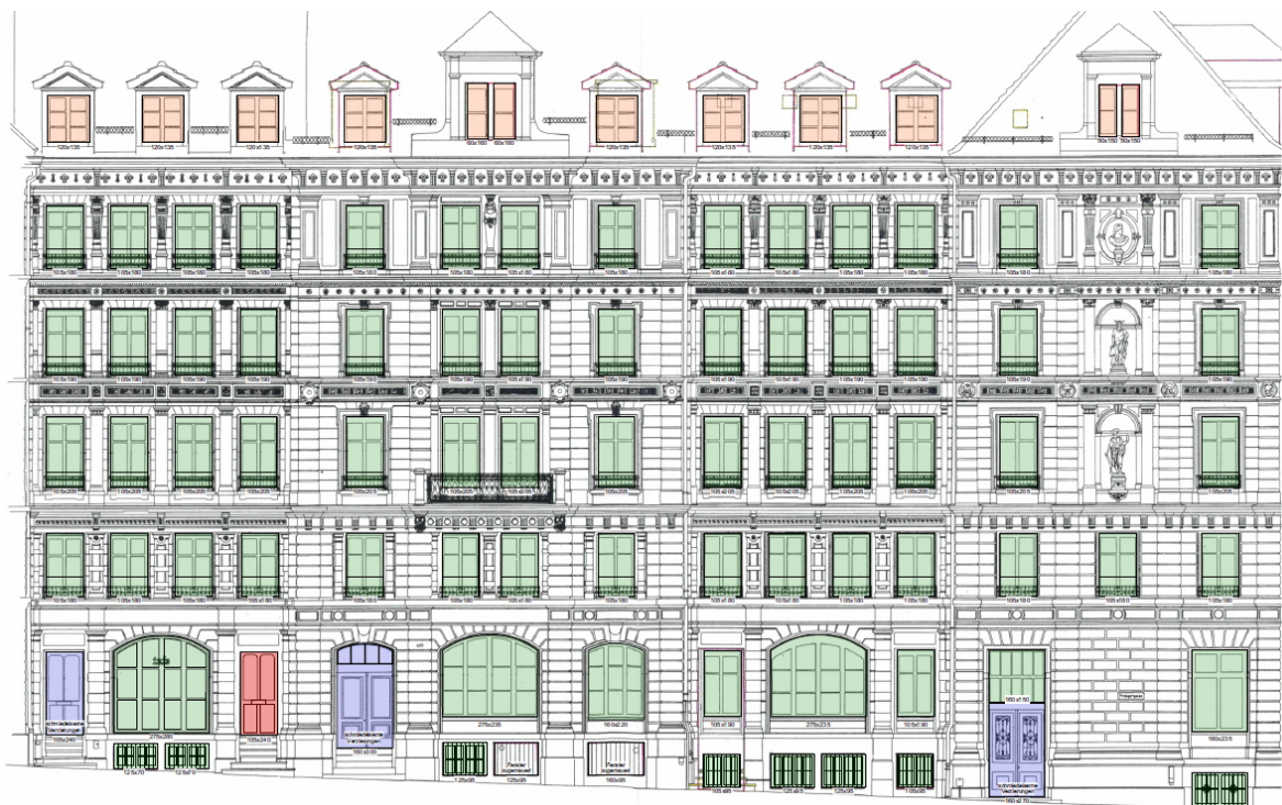
Ostfassade mit der Katalogisierung der verschiedenen Fenstertypen
