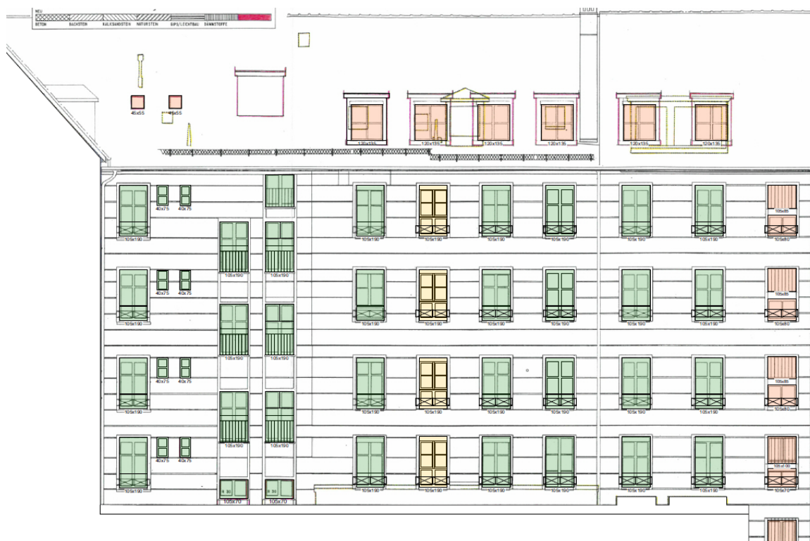
Westfassade mit der Katalogisierung der verschiedenen Fenstertypen
